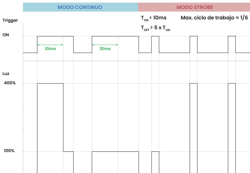
Para el funcionamiento en modo Strobe, se recomienda que la fuente de alimentación sea el doble de potente que la lámpara en modo Strobe.
